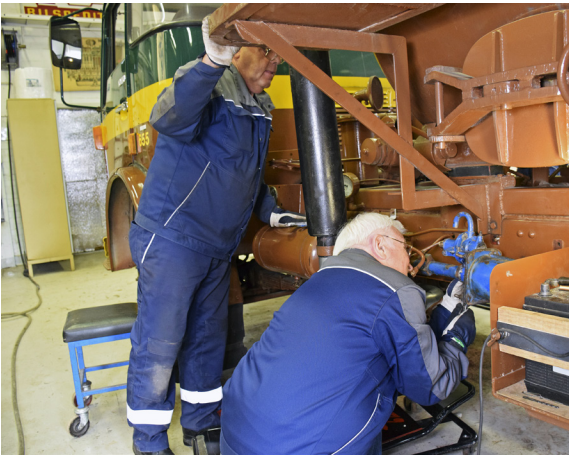
Bernt Forsberg och Bent Pedersen byter servocylinder till bromsarna på Volvos F85 slamsugare.
